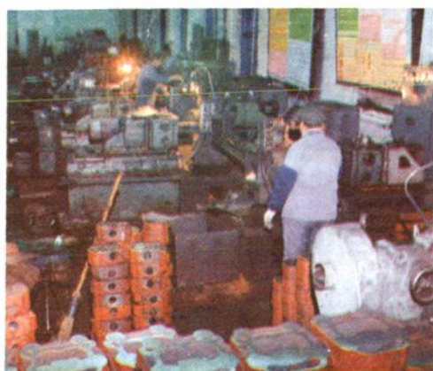
气缸盖生产线
