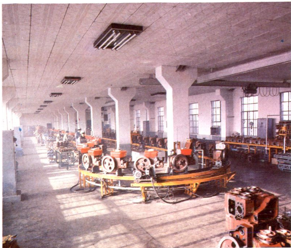
新建的柴油机自动循环装配线
