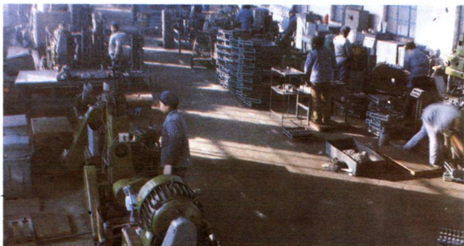
柴油机 连杆生产线
