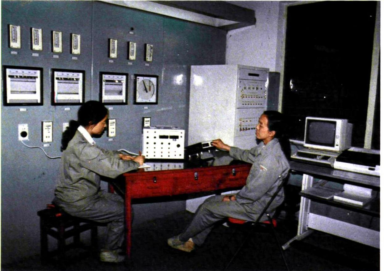
仪表维护工校验热工仪表
