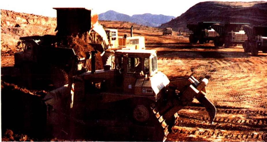
D8L 推土机 / 988b 前装机 / B-540 自卸车联合作业。
