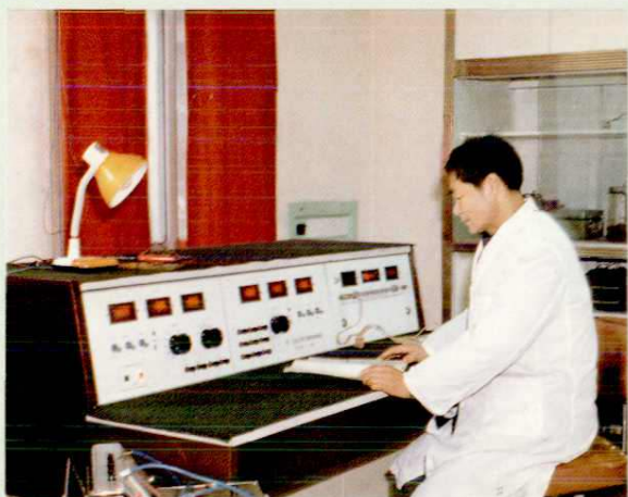
江西省电力试验研究所研制的 CKT-1 型程控三相校表台
