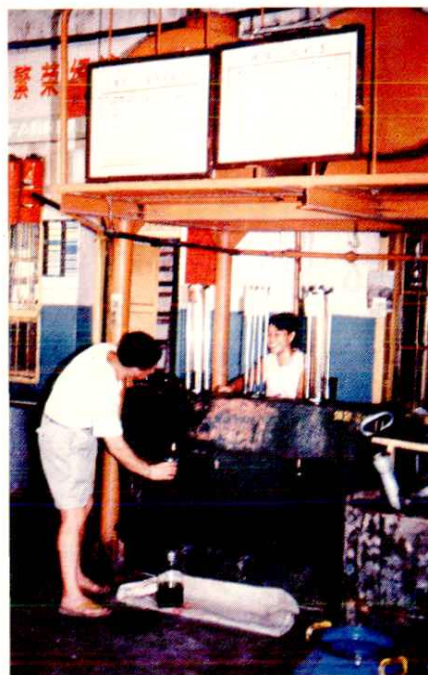
高架油罐和液压售油器
