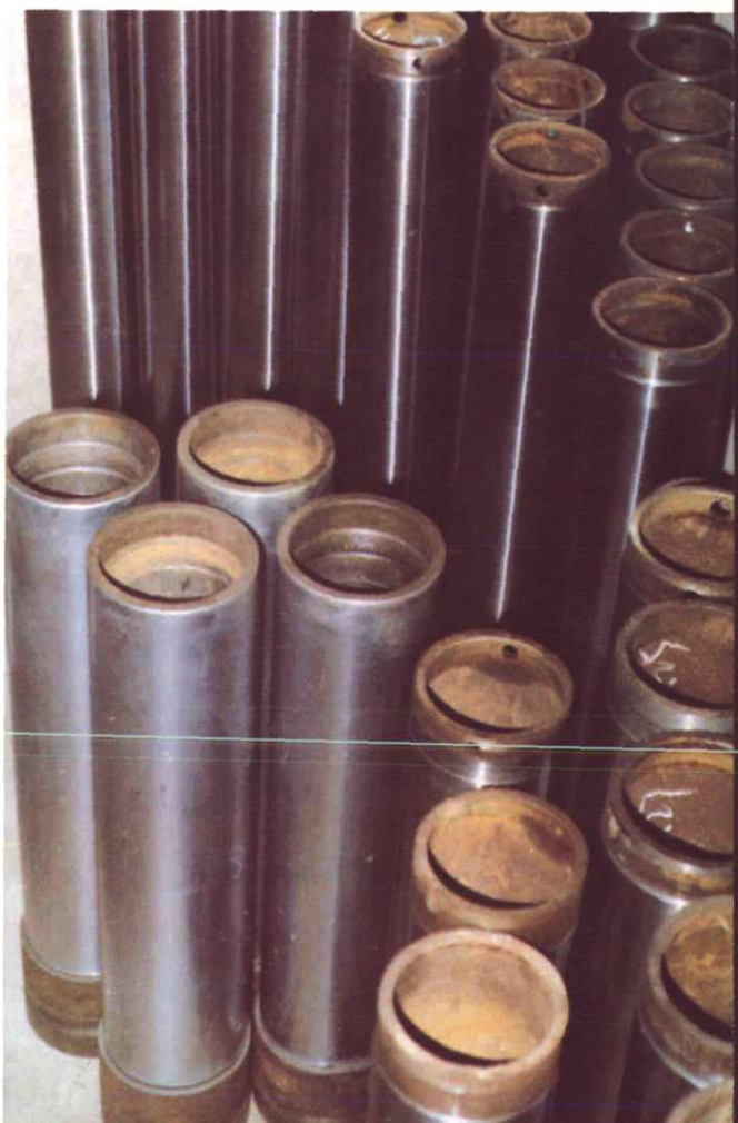
低温镀铁工艺修复综采设备零件
