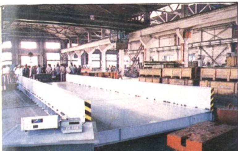
SCS-30 型 系列无基坑电子汽车衡
