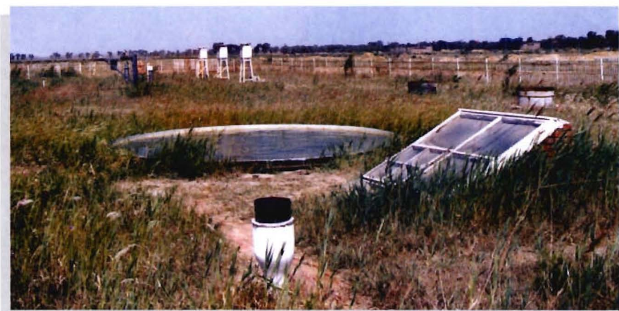
▶ 衡水蒸发实验场二十平方米 蒸发池及防冻设备
