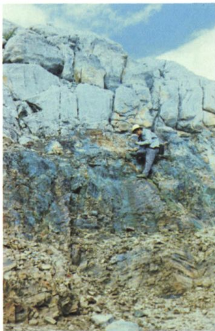
▼ 43 1997年, 区调队对白玉县连龙西支沟锡铜多金属矿进行普查, 对大理岩与角岩接触带上的矽卡岩锡铜矿体进行观察和采样。范晓摄影
