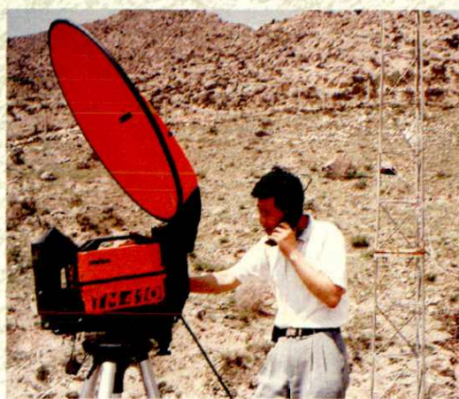
技术人员调试便携式微波应急通信设备
