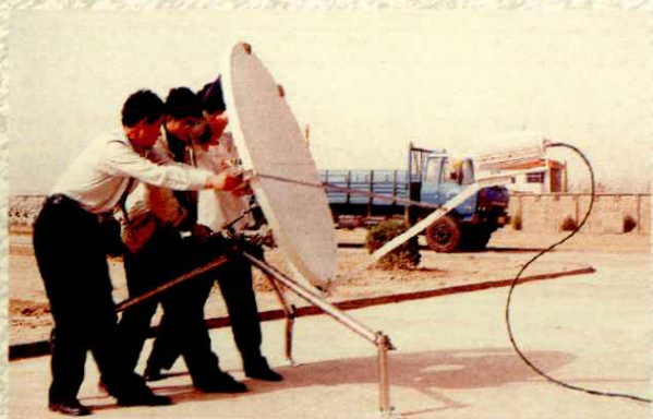
技术人员调试VSAT卫星应急通信设备
