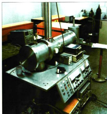
■ 二极管激光光谱仪
