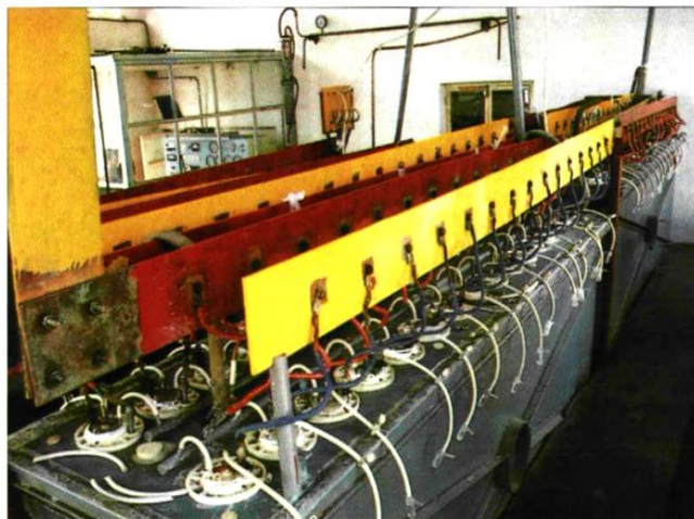
■ 氯酸盐电化学生产新工艺的工业电解槽
