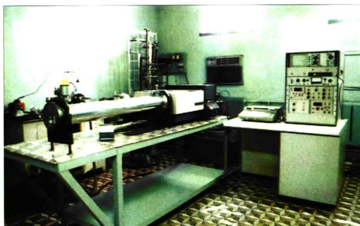
■ 二极管激光光谱仪
