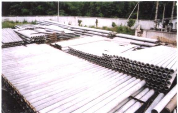
电力修配厂生产的预应力水泥电杆
