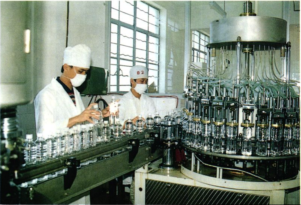
图为采用国际先进技术，引进美国CAVTON设备生产，年产5000吨以上的矿泉水厂车间。
