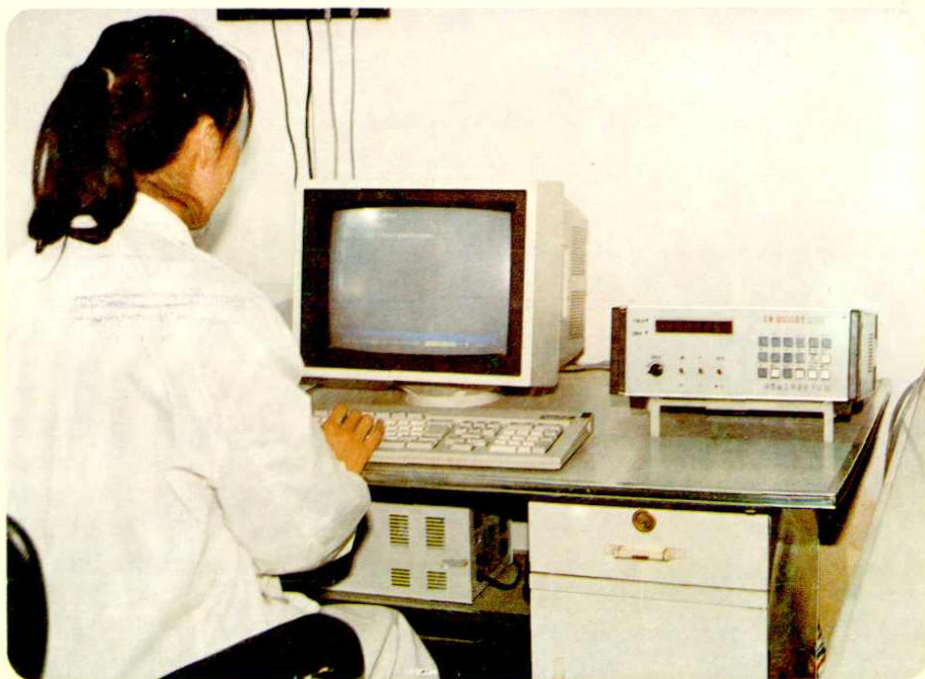
△ 图为第一粮库保管员正在使用微机测控粮温
