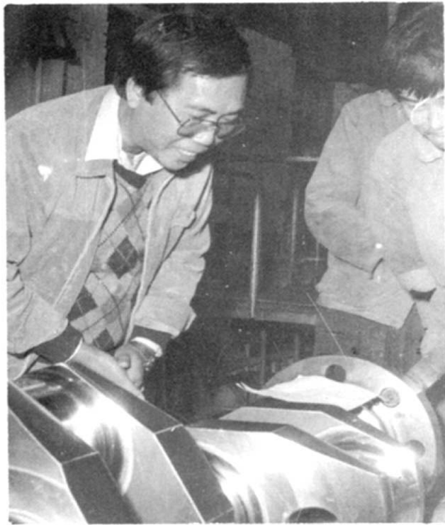
美国ABS船检社何荣基先生在检查6250ZC型柴油机曲轴质量。
