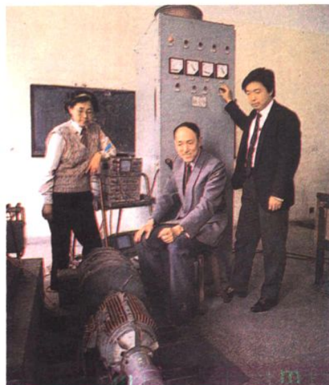
自动化系获国家专利的解耦变频调速 工业应用装置在进行系统调试
