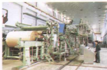
自动化控制的三长网涂布纸机，具有90年代国际先进水平的涂料制造设备、涂布机及全自动监测控制系统
