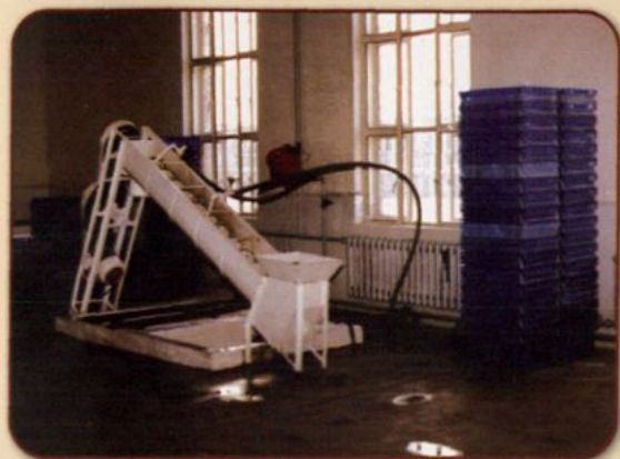
鲜果清洗车间一角 图为农机所研制的洗果机
