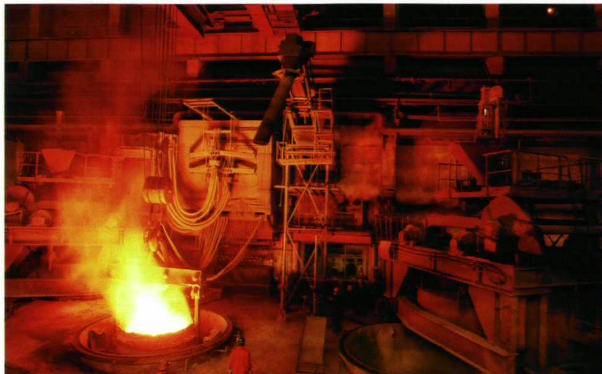
抚钢股份公司第二炼钢厂30/60吨VOD/VHD炉外精炼炉
