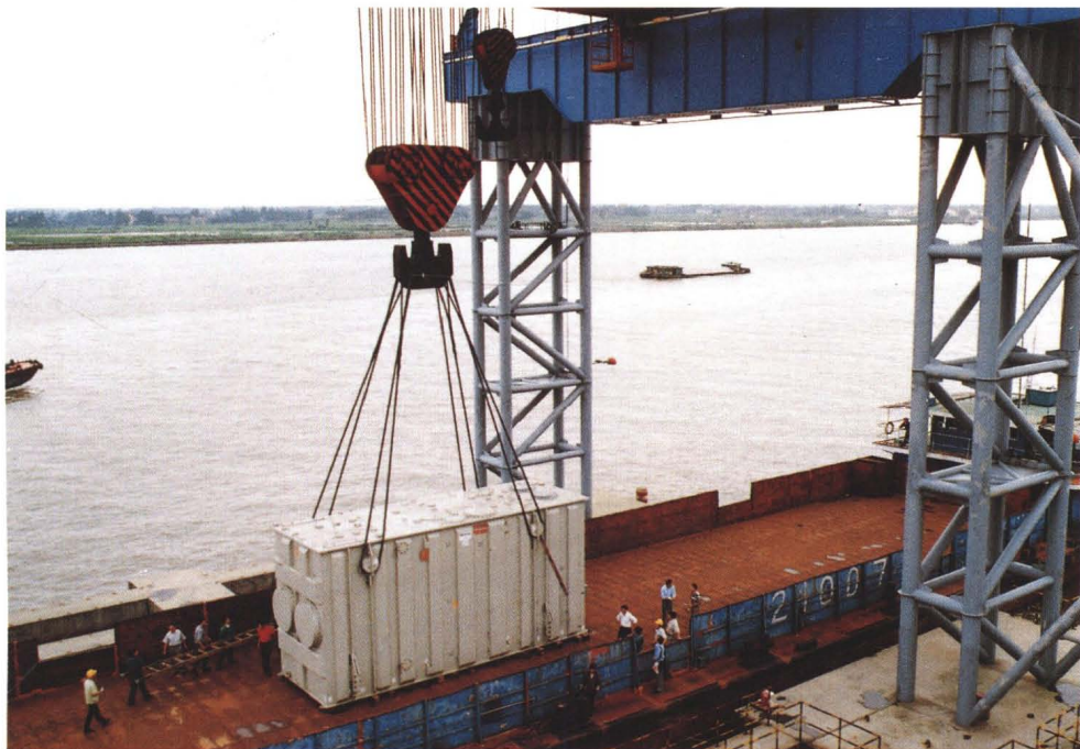
在上海电机厂货运码头，利用600T龙门吊实施水路转运，水运选用千吨级驳船为运输船，运抵宜昌虾子沟码头
