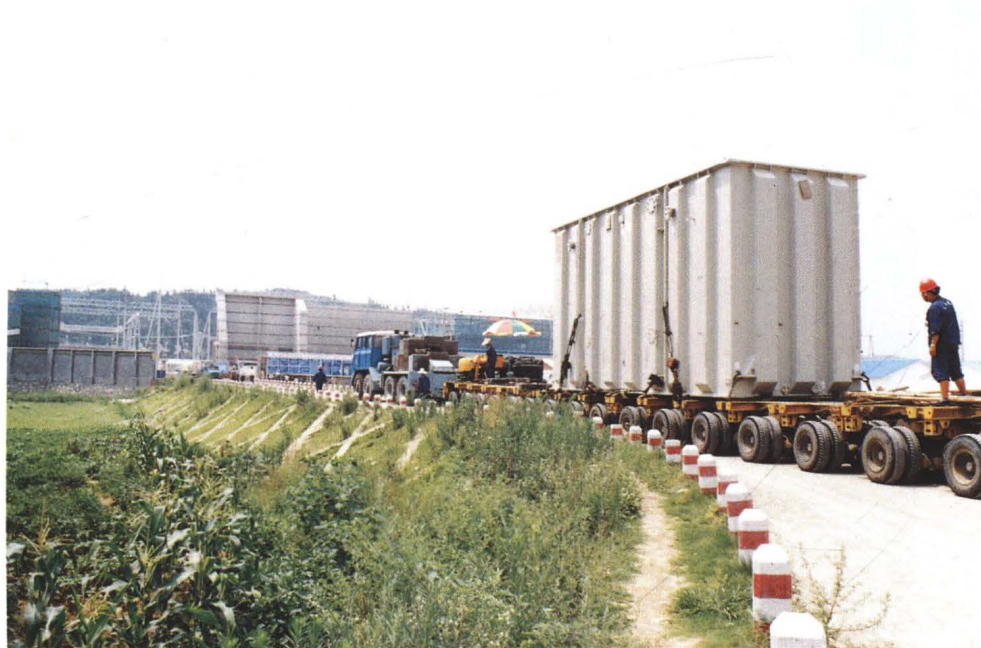
从宜昌虾子沟码头通过400T平板车实施公路运输，西变厂三峡直流产品正驶入龙泉换流站
