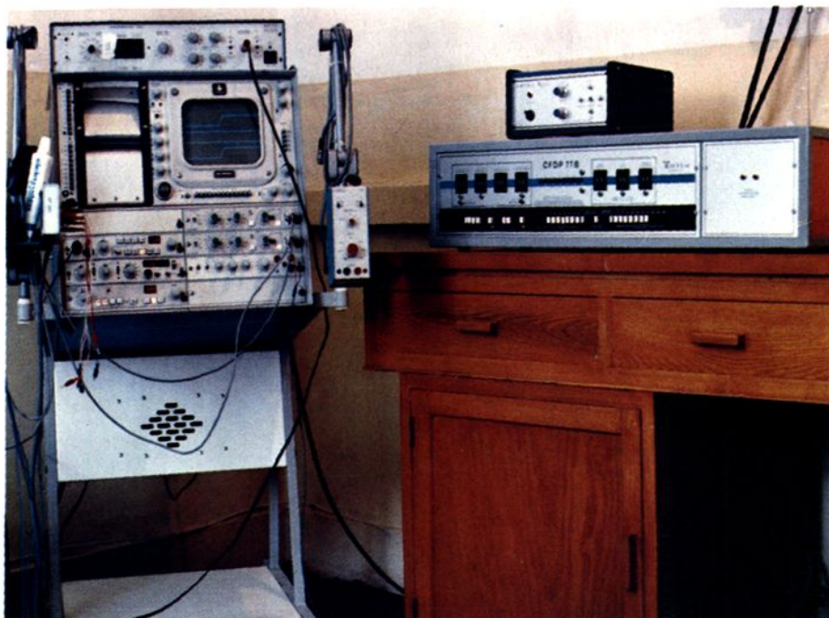
神经耳科装置MS - 6 主要用途：听脑干、耳蜗电位，眼震电图等。
