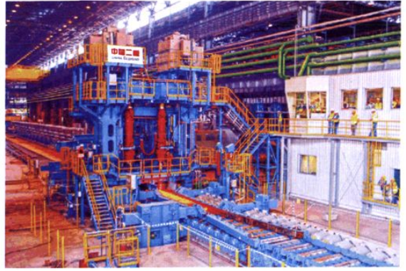
二重制造的2250毫米热连轧机是中国冶金成套设备首次出口欧洲国家
