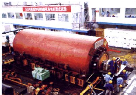
东电生产的400兆瓦燃汽轮发电机
