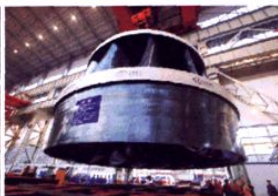
东电自主开发研制的三峡右岸水轮机转轮
