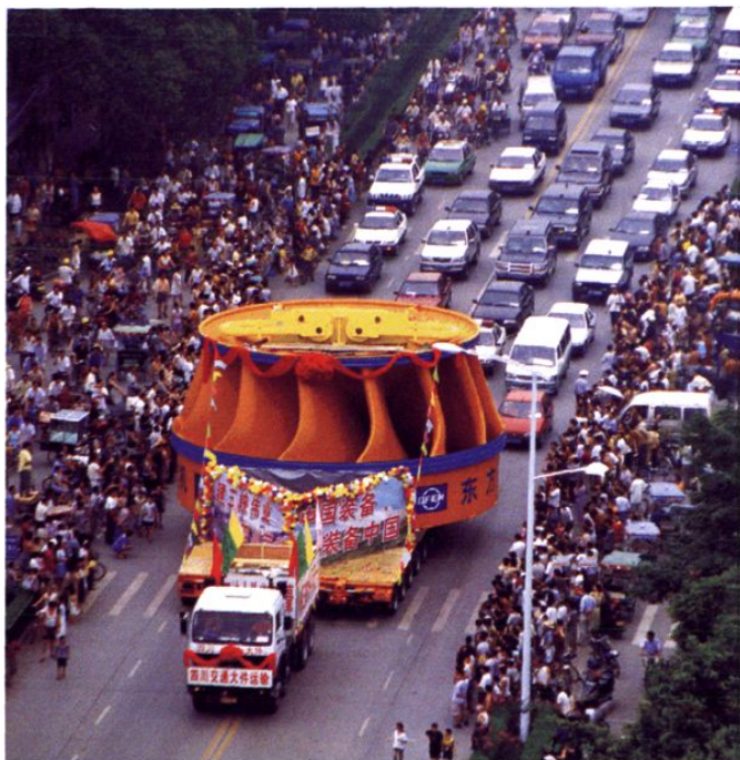
2003年8月8日，东电生产的国内首台三峡70万千瓦水轮机转轮发运
