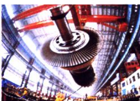
2011年2月9日，东汽生产的燃机转子进入动平衡实验室验收
