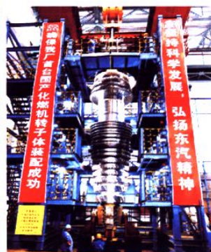
东汽生产的首台国产化核电转子
