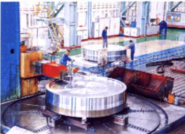
二重实现核电产品由单件向批量化生产转变，图为加工中的1000兆瓦核电管板
