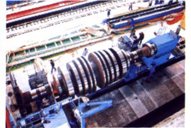
二重为福建宁德核电项目生产的AP1000低压转子
