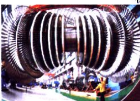
东汽生产的火电机组汽轮机转子
