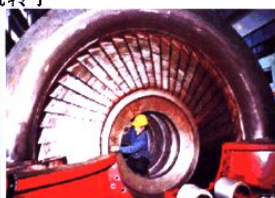
东汽研制的核电汽轮机
