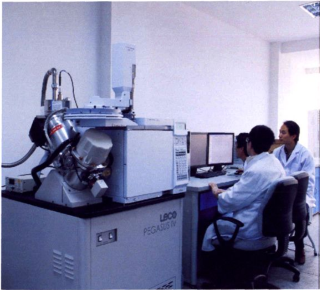
剑南春集团采用美国LECO全二维气相色谱—飞行时间质谱联用仪进行剑南春酒个性特征分析
