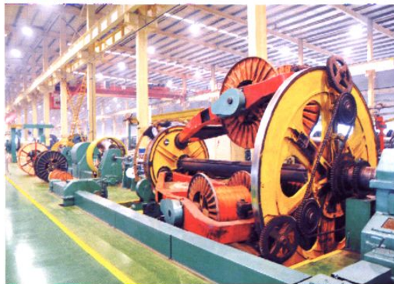
特变电工（德阳）现代化的流水生产线2-3.5米成缆机
