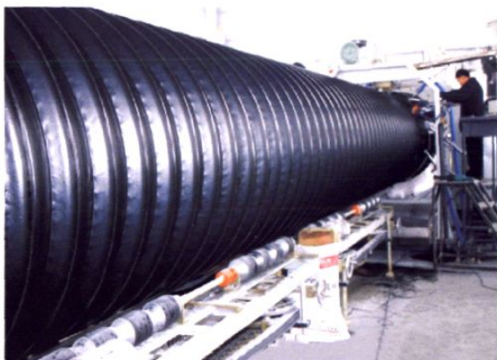
金路集团塑胶公司生产的 钢骨架缠绕塑料管
