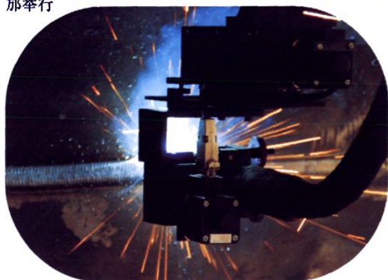
四川什邡科新机电设备公司机器人自动焊接
