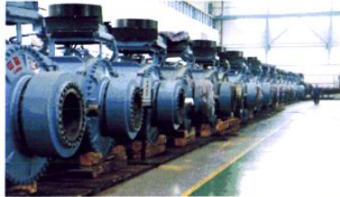
2009年9月22日，二重自主设计的2.5兆瓦风机增速箱在二重精衡公司一次性试车成功。标志着二重大功率级风机增速箱研发处于全国领先水平
