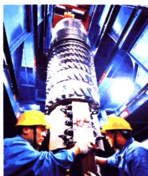
东汽生产的国产化核电转子
