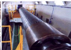
东电的转子动平衡超速试验室
