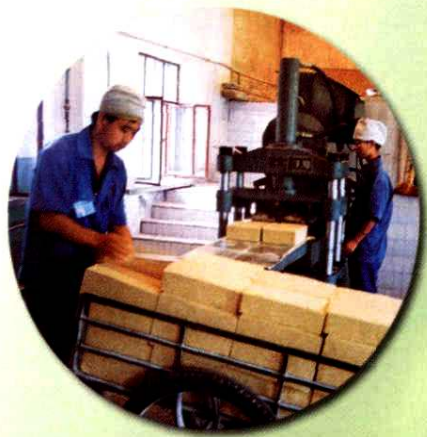
酒厂在技改中,引进大量新技术、新工艺。图为机械制曲
