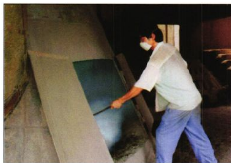
▲ 机窑煅烧操作
