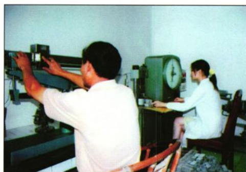
▲ 质检人员做水泥抗折抗压检验
