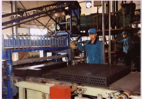
多孔砖成型压制工序
