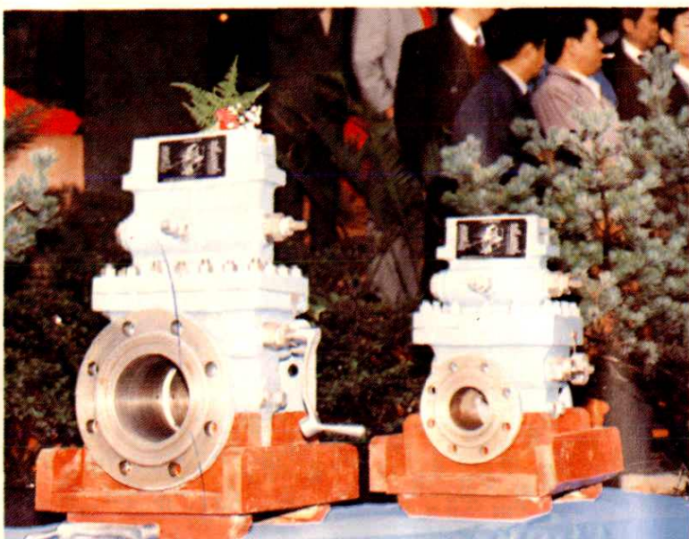
▲1988年获国家实用新型专利的阀式孔板节流装置
