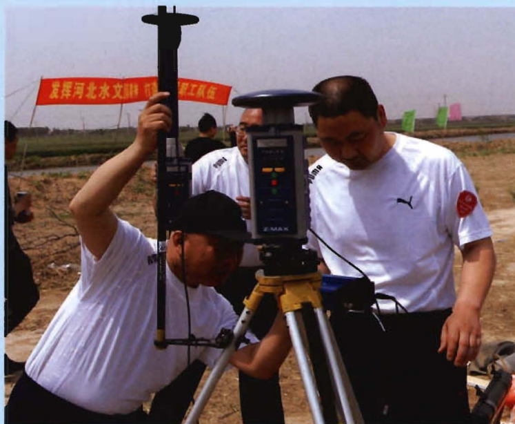
2009 年，河北省水文水资源勘测局在沧州献县引黄输水河段进行水文应急能力学习比赛，图为水文勘测工在大赛现场用 GPS 测量大断面
