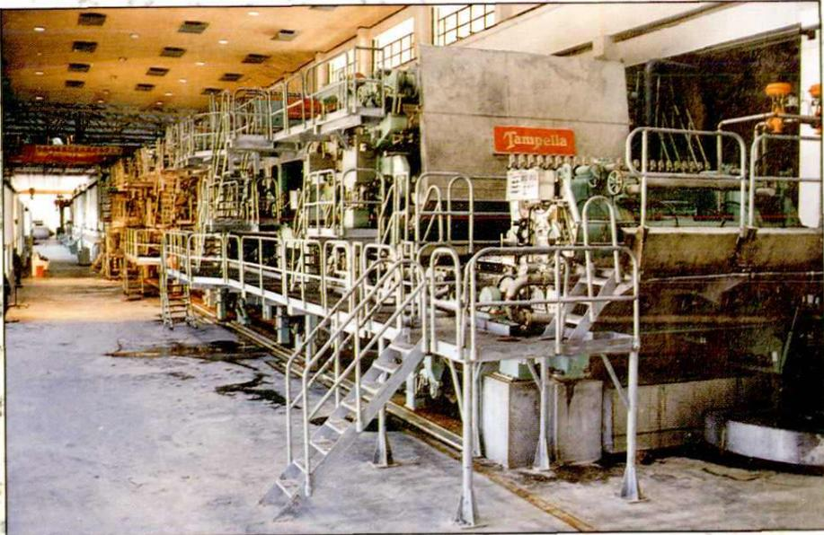
年产5万吨牛皮箱板纸机(宏文造纸厂)
