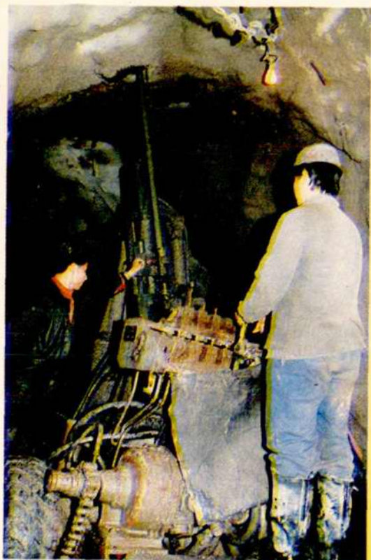
▲ 井下CYQ—80潜孔凿岩机在作业
