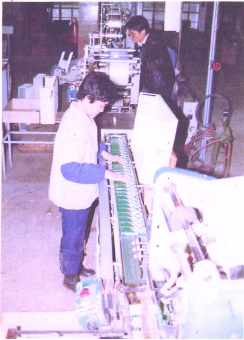
4. 进口mk 8 女式雪茄机组在正常的运行中。
