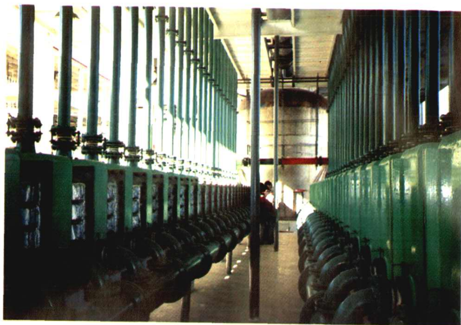
福州第一化工厂自行研制的1万吨/年氯酸盐FA—II 40电解装置
