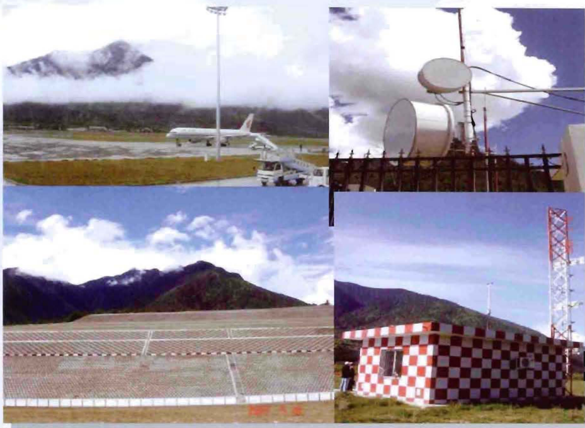
自2004年9月起，中国民用航空总局空中交通管理局在林芝机场开展了GBAS试验系统的探索和研究开发工作。图为设置于林芝机场的GBAS试验系统。
