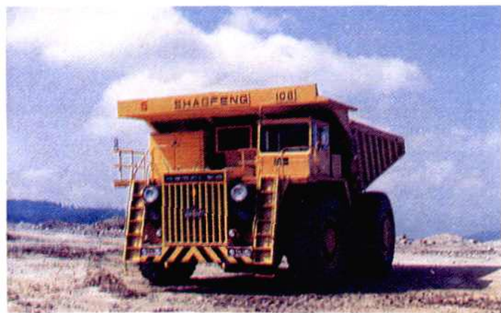
108t 电动轮自卸车在矿山运行
