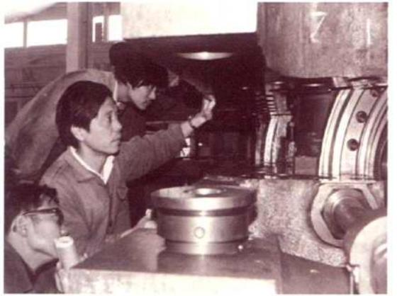
1983年11月,总装工人正在安装T6008“52万吨尿素装置驱动用汽轮机”。
