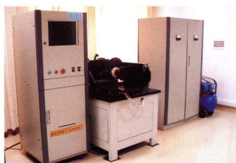
汽车启动机综合性能试验装置
