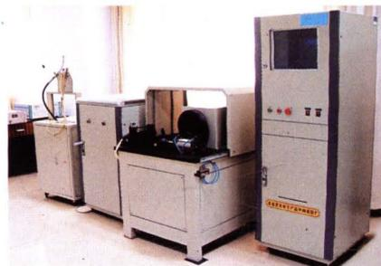
汽车发电机综合性能试验装置
