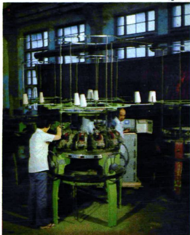
海门县交通(纺织)机械厂生产的ZD261-A型电子提花毛皮机和织出的人造毛皮。它利用微机控制,生产的仿兽皮人造提花毛皮富有真实感,质地柔软,保暖性好,收深受消费者喜爱。
