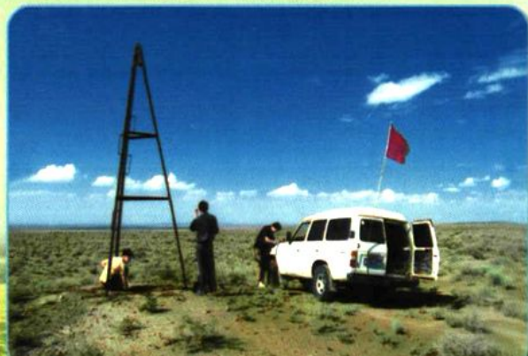
对测量标志完好情况进行检查
