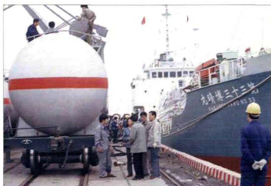
车船直取出口液体化工产品港口现场
