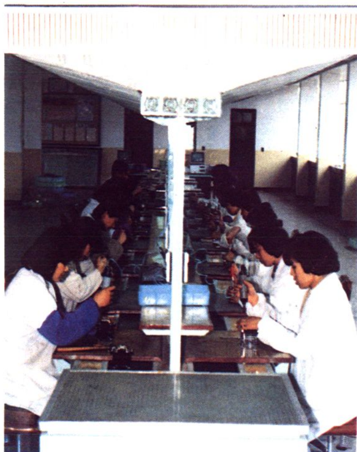
新建成的交流接触器装配流水线
