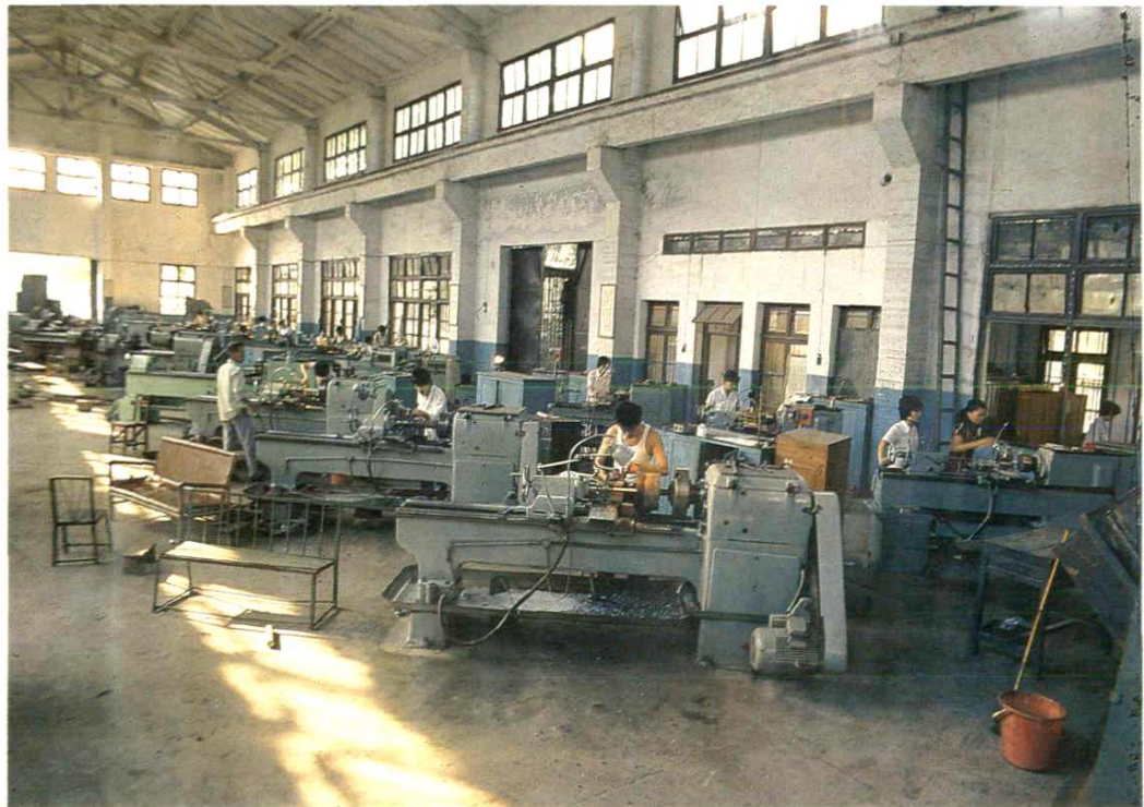
↓ 修配車工班正在加工大修用備品配件
