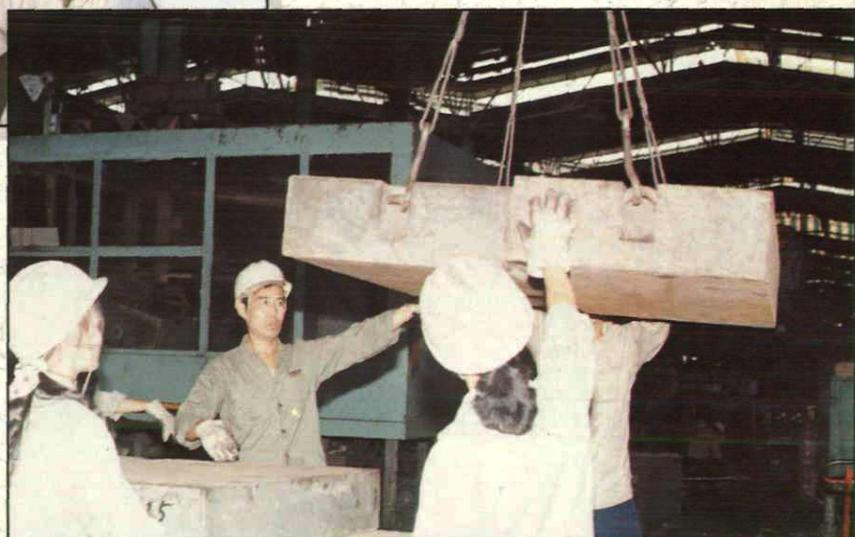
衡检和安装人员在校对热轧厂热平整秤
