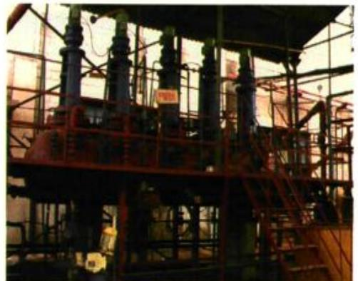
高铁闪熔矿高压酸浸过程
