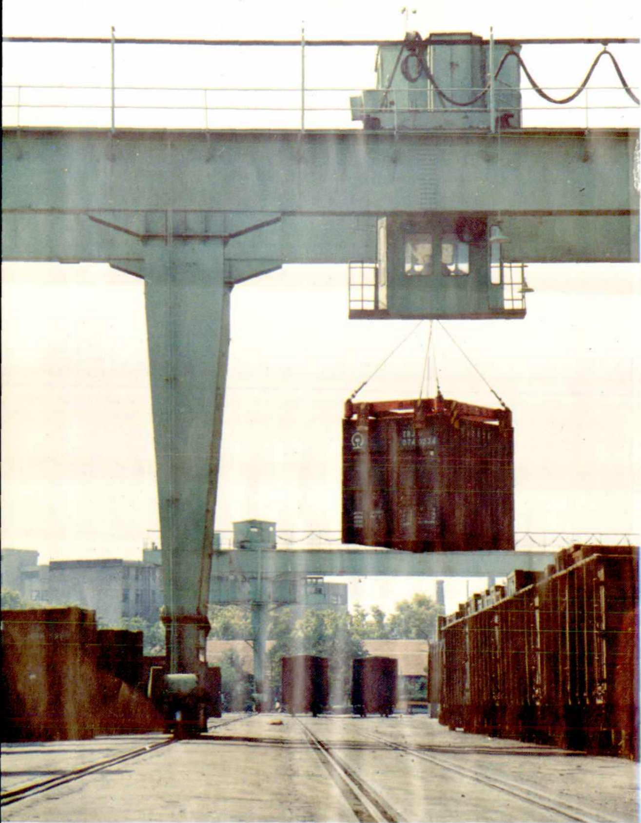
这是集装箱货场的龙门吊在进行装卸作业。
