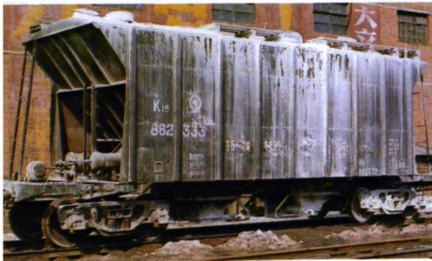
K 15 型旧型散装水泥漏斗车， 1967年齐厂制造。
