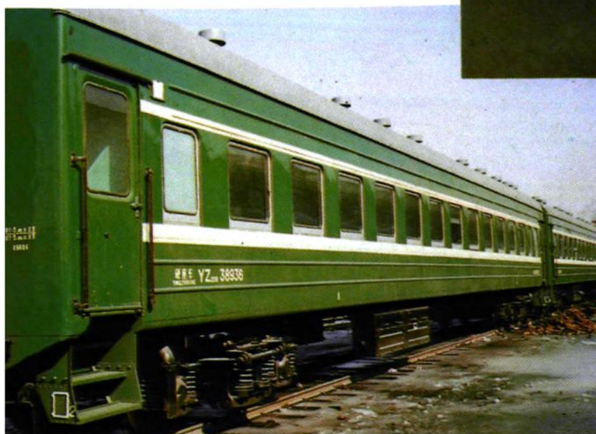
YZ 22B 型客车，由长春、 唐山客车厂制造
