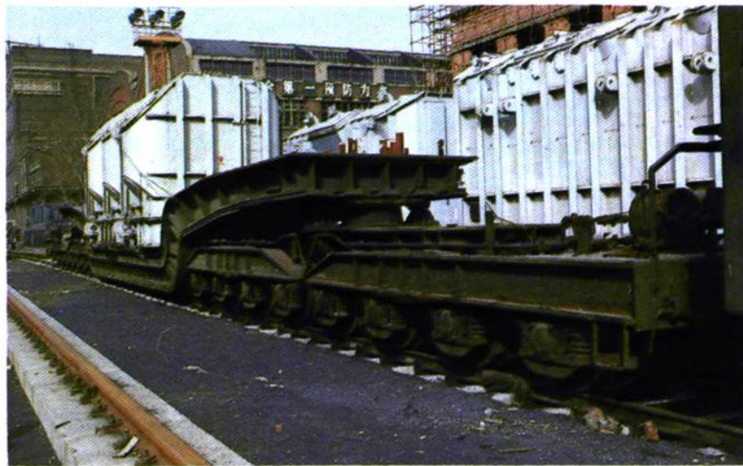
D 2 型长大货物凹底平车
