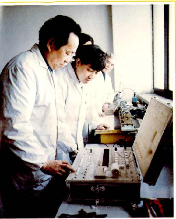
汽机室技术人员进行消除汽轮机振动的试验研究
