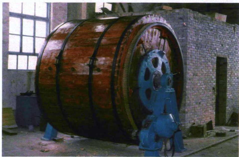
二轻机械厂生产的大型鞣革机具可倾式和仿意水平悬挂式现代化转鼓
