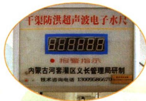
2001年义长管理局自行开发研制的“干渠防洪超声波电子水尺”
