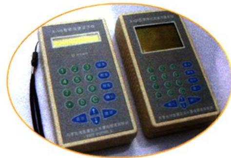
2003年义长管理局自行开发研制的“x-v5智能流速显示仪”以及汉字显示的流量测算装置
