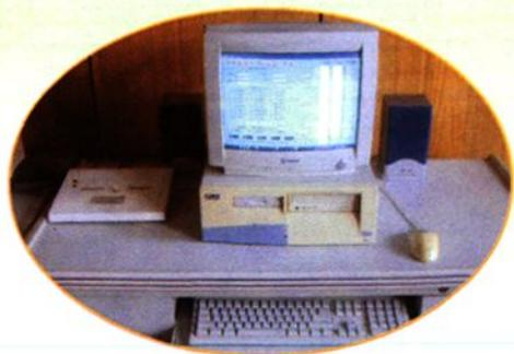
1999年义长管理局自行开发研制的“水情显示屏上传软件”以及“用900兆电台远程监测分水枢纽闸门高度与水位”的装置主机
