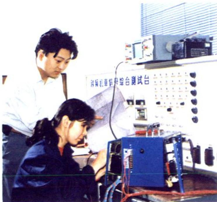
▲检修测试移频机车信号。
