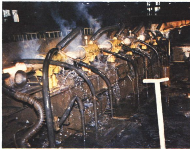
钢管连续控制冷却装置
