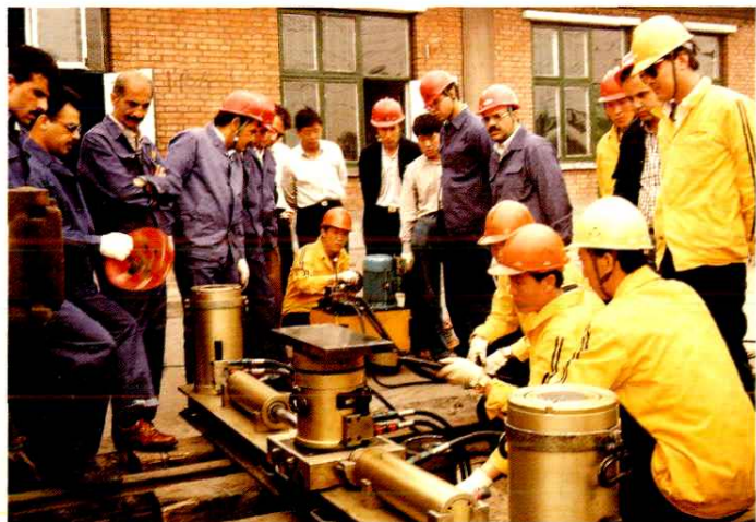
机务段救援列车人员为前来学习的伊朗德黑兰地铁公司员工演示液压起复技术
